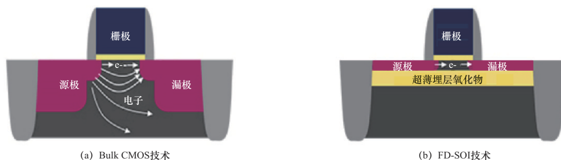
图3 Bulk CMOS与FD-SOI的结构对比
